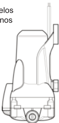
Fig 2 - Orientación de montaje de la bomba recomendada
