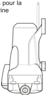
Fig 2 - Orientation recommandée du montage de la pompe
