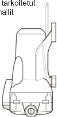
Kuva 2 - Suositeltu pumpun asennussuunta
