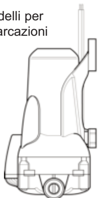
Fig 2 - Orientamento raccomandato per il montaggio della pompa
