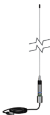
90CM 3 DB AIS ANTENNE med krom fæste. 4,5m. RG58 kabel og stik. Rustfri stål pisk.
