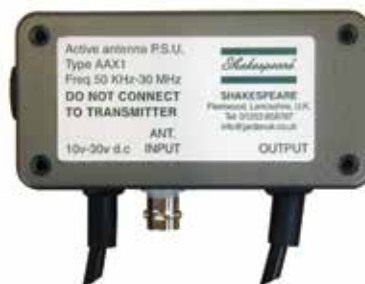
STØMFORSYNING til Navtex kan bruges med AA20.
